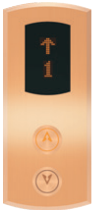
标准配置 HOP11-04 面板: 发纹不锈钢镀玫瑰金 按钮: B11H-012 显示: 橙色点阵
